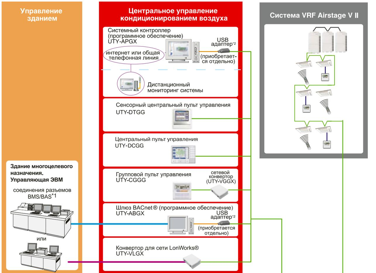
\*1. Система диспетчеризации инженерного оборудования здания/Система управления зданием.
