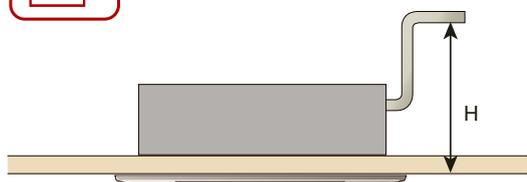
В сплит-системах канального типа ARHG12-18LLTB дренажный насос также идет в комплекте с внутренним блоком и не требует дополнительного монтажа.
