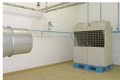
Камера для испытаний при орошении водой
