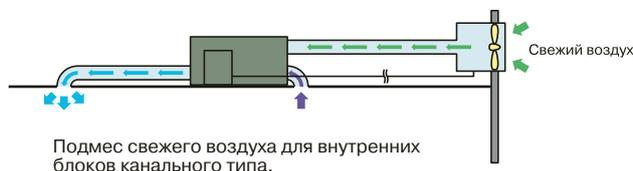
Подмес свежего воздуха для внутренних блоков канального типа.
