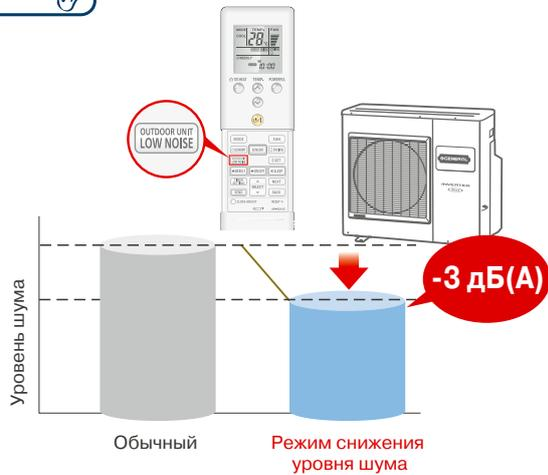
В коммерческих сплит-системах с помощью соединительного кабеля для подключения внешнего управления UTY-XWZXZ2, используя стандартный разъем и плату управления наружного блока, вы можете принудительно снизить уровень шума наружного блока. Снижение шума происходит за счет снижения рабочей частоты компрессора и скорости вращения вентиляторов. Доступно два уровня снижения шума: на 2 дБ(А) и на 4 дБ(А).
