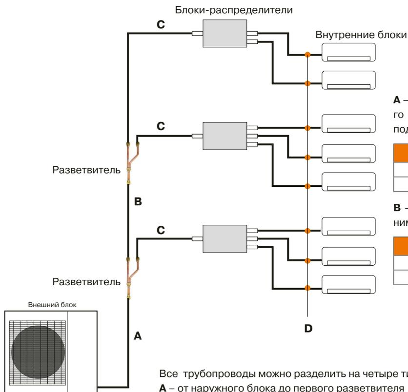
**A** – диаметр труб от наружного блока до первого разветвителя соответствует диаметру труб, подключаемых к наружному блоку:
