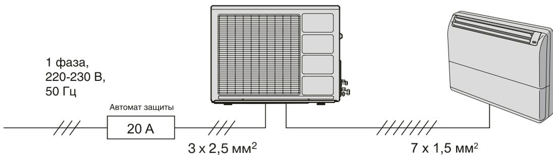
**Примечание:** схемы электрических соединений демонстрируют только структуру системы. Внешний вид наружных и внутренних блоков может отличаться.
