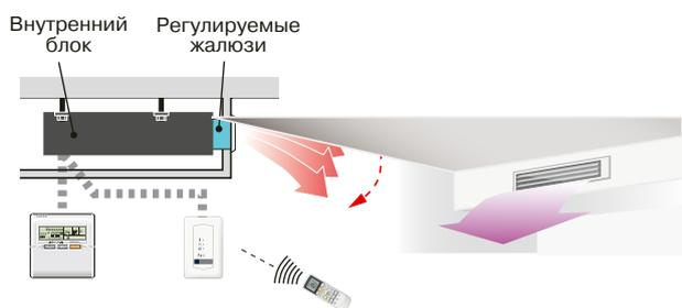
Регулирование воздушного потока для внутренних блоков канального типа может осуществляться с помощью регулируемых жалюзи. Жалюзи регулируются с пульта управления. Для моделей ARHG12-14L используются шлюзы UTD-GHSA-W а для ARHG18L – UTD-GHSB-W.
