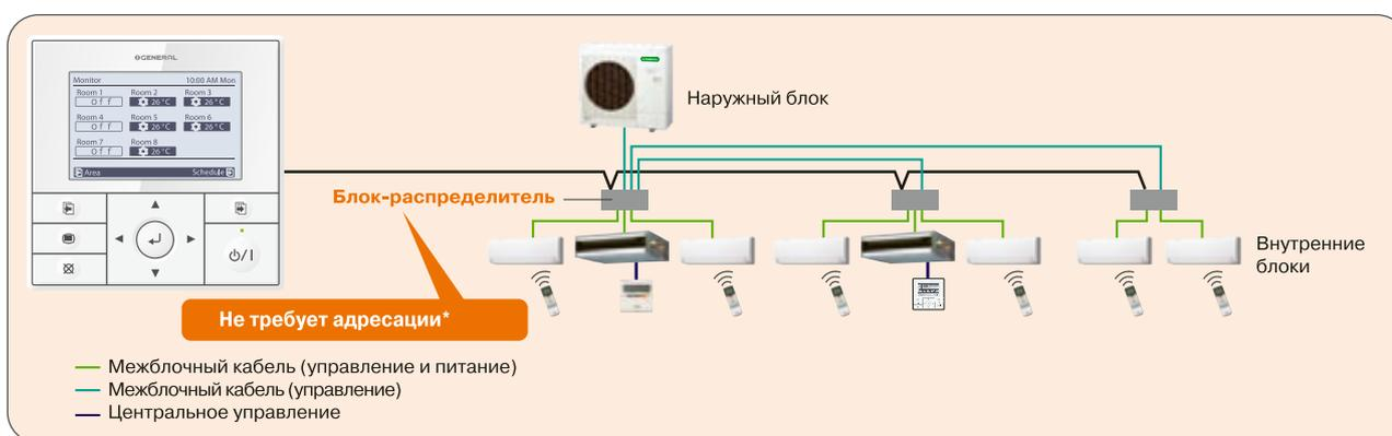
**Примечание:** Не допускается перекрестное соединение кабелей и трубопроводов. Не допускается установка групп.
