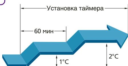
В режиме охлаждения: температурная уставка автоматически повышается на 1 °С каждый час (но не более, чем на 2 °С).
