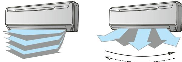
В режиме обогрева теплый воздушный поток направляется почти вертикально вниз для более интенсивного кондиционирования воздуха в помещении. Мощная струя теплого воздуха обеспечивает поддержание комфортных параметров даже на уровне пола.
