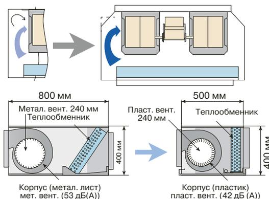
Примечание: измерение шума при напоре 100 Па.
