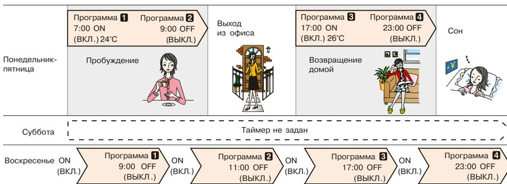
Таймер позволяет задать не только включение-выключение блока, но и режим работы, температуру. В новом пульте UTY-RVNGM есть возможность задания двух расписаний для разных сезонов.
