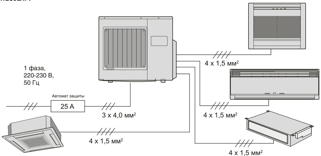
**Примечание:** схемы электрических соединений демонстрируют только структуру системы. Внешний вид наружных и внутренних блоков может отличаться.
