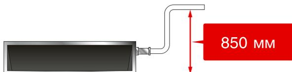
В сплит-системах подпотолочного и канального типа возможна опциональная установка дренажного насоса, рекомендуемого GENERAL, или насоса стороннего производителя.
